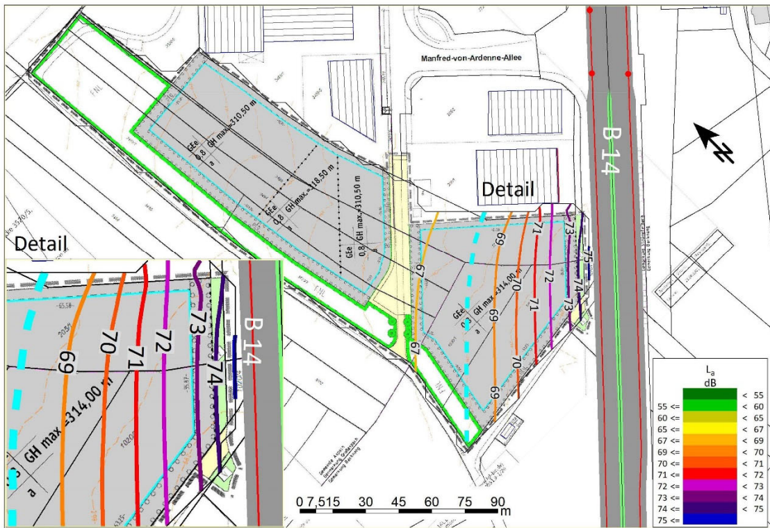
Abb. 3: Maßgebliche Außenlärmpegel nach DIN 4109
